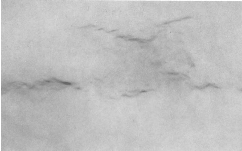
Fig. 15-8. Hot cracks (hot tears)
